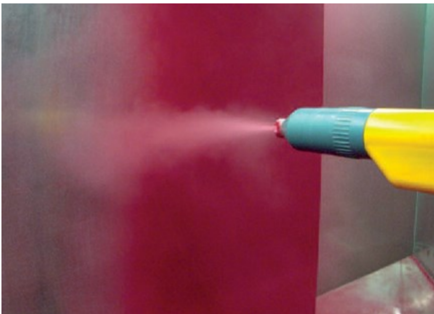
Abbildung 7: Applikation des Pulverlackes durch Sprühen.
